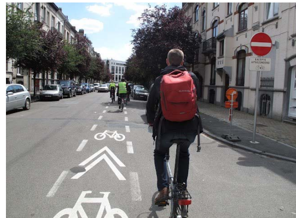
Avenue Milcamps (SUL généreux avec marquage de PCM sur toute la longueur)
