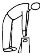
Veiller à entreposer les éléments dans un certain ordre afin de ne pas devoir les manipuler plusieurs fois. Prévoir le stockage des éléments démontés à une hauteur de 80cm.
