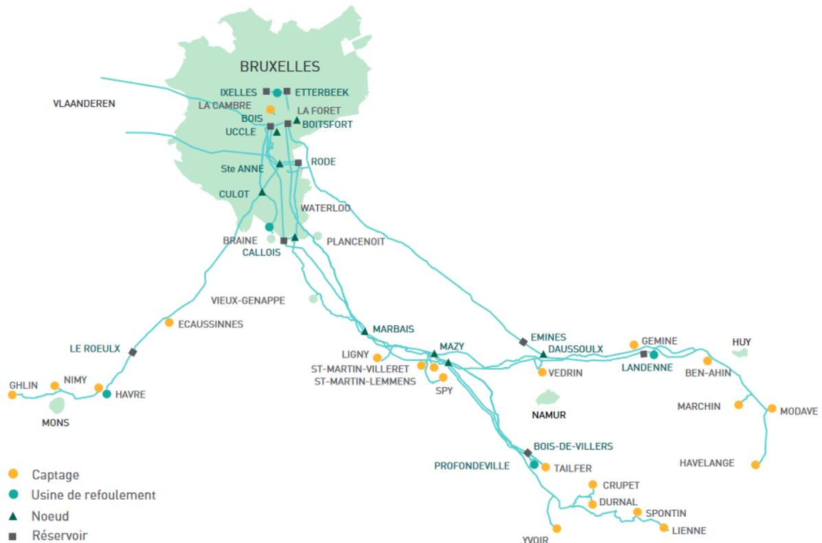
Figure 40. Activités de production, stockage et transport d'eau potable de VIVAQUA (VIVAQUA, 2020b).
