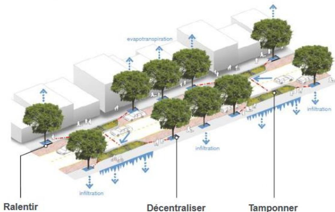
Figure 54. principes de la gestion intégrée des eaux pluviales (Bruxelles Environnement)
